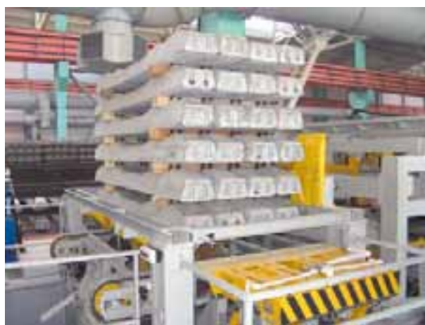
Рис. 4. Автоматическая линия по сборке рельсошпальной решетки
