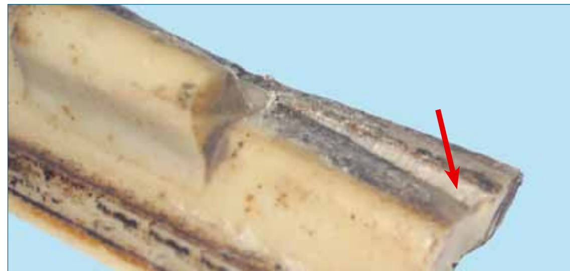
б) Деформация уголка изолирующего при анкерах 1-го исполнения Стрелкой показан след на уголке изолирующем от выступа на анкере первого исполнения
