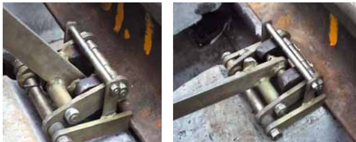
Рис. 20. Устройство для извлечения «заклинившихся» уголков изолирующих (в том числе, реализуется микросдвигка рельса)
