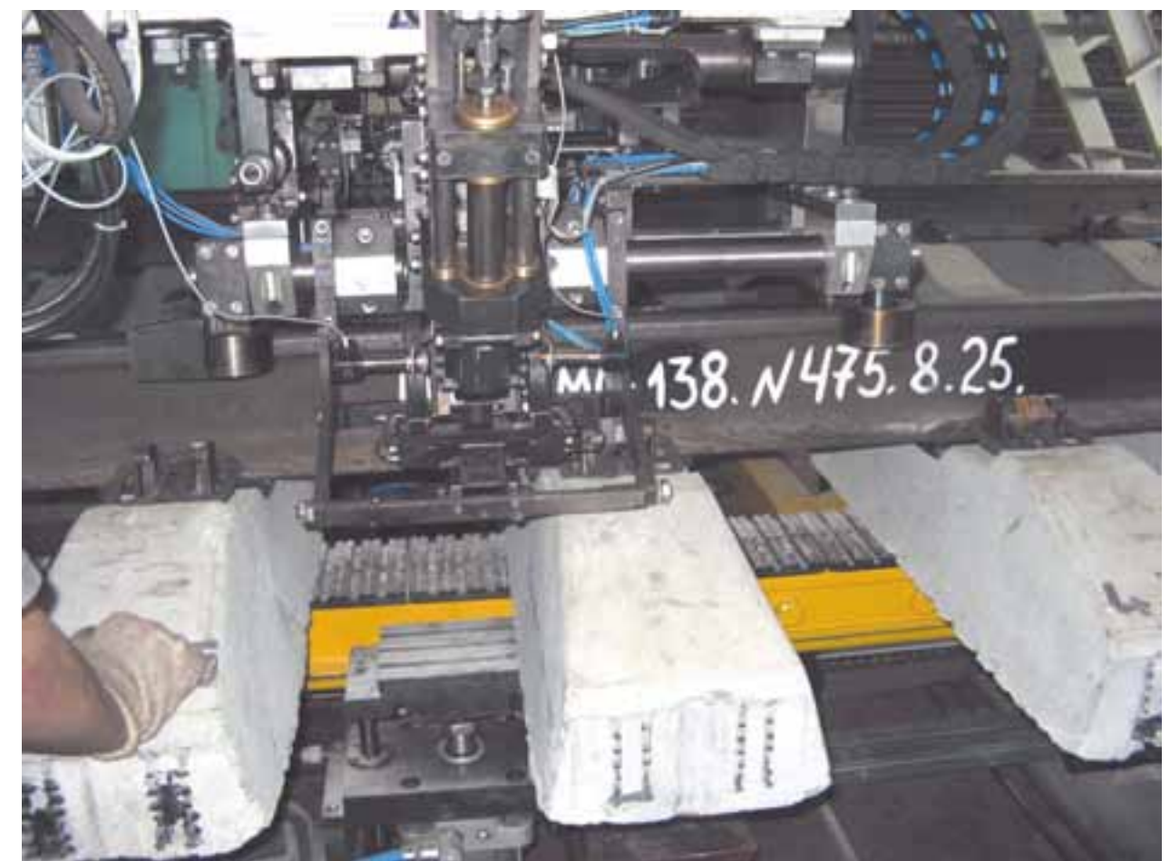
Рис. 4. Автоматическая линия по сборке рельсошпальной решетки (продолжение)
