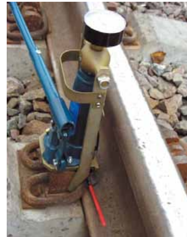
Рис. 14. Прибор для измерения усилия прижатия рельса
