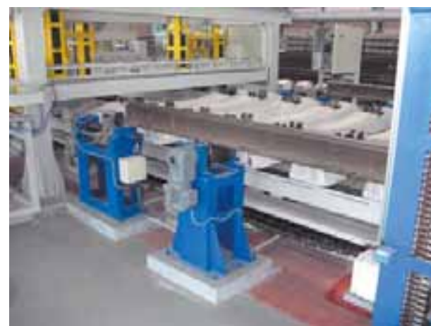
Рис. 4. Автоматическая линия по сборке рельсошпальной решетки
