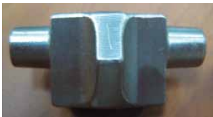
Рис. 11. Монорегулятор из стали 45
