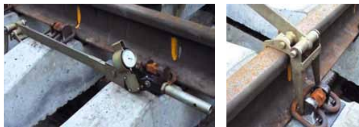
Рис. 21. Устройство для измерения силы прижатия пружинной клеммы
